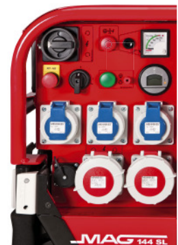
einfach und übersichtlich durch die optimale Anordnung aller Bedienelemente Isolationsüberwachung mit akustischer Warnung durch Hupe nach DIN 14685-1
